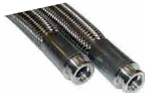
PTFE-Wellschlauch mit Spirale und Polypropylenumflechtung sowie Losflansch aus Edelstahl mit gebördelter PTFE-Innenschicht
