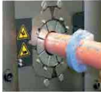
LS-Werkbild: Beim Verpressen von PAGUFIX-Kupplung und Purpurschlange-Schlauch ...
