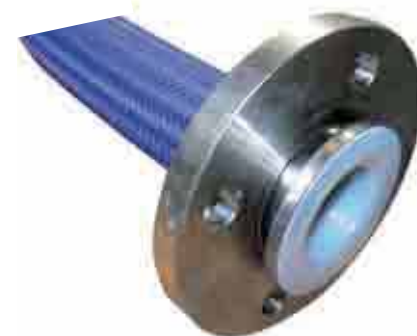
PTFE-Wellschlauch mit Spirale und Polypropylenumflechtung sowie Losflansch aus Edelstahl mit gebördelter PTFE-Innenschicht
