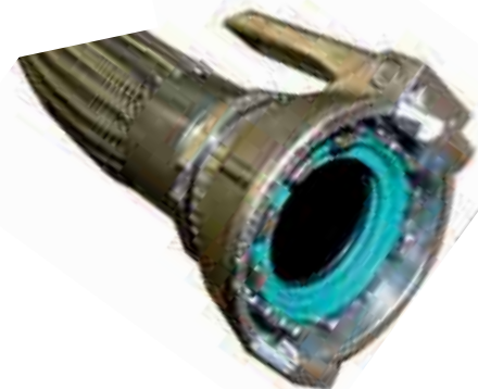
PTFE-Wellschlauch mit Spirale und Edelstahlumflechtung sowie TW-Kupplung MK 50 und gebördelter PTFE-Innenschicht antistatisch
