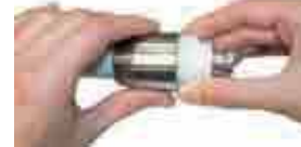
mit Edelstahlhülse verschrauben
