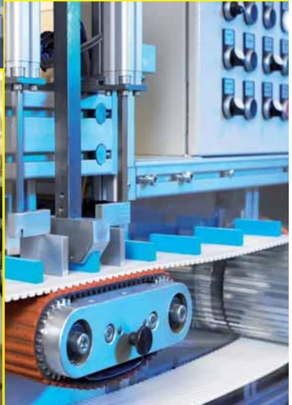
**Standard-Zahnriemenscheiben** aus Stahl, Aluminium oder Grauguss mit patentierter Verzahnungsform garantieren ein gleichmäßiges und ruhiges Abwälzen der Riemenzähne in der Scheibe; **auf Wunsch sind Zahnriemenscheiben in Sonderteilung bzw. nach Zeichnung lieferbar.**
