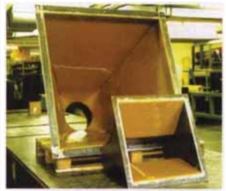
Trichterauskleidungen mit Verschleißgummi
