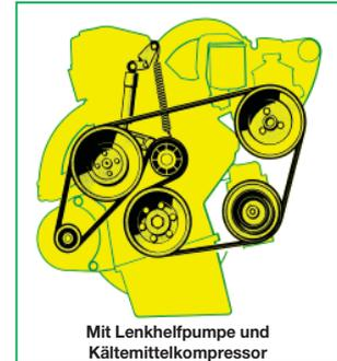
Werkbild Mercedes Benz: (Schemazeichnung Keilrippenriemen)
