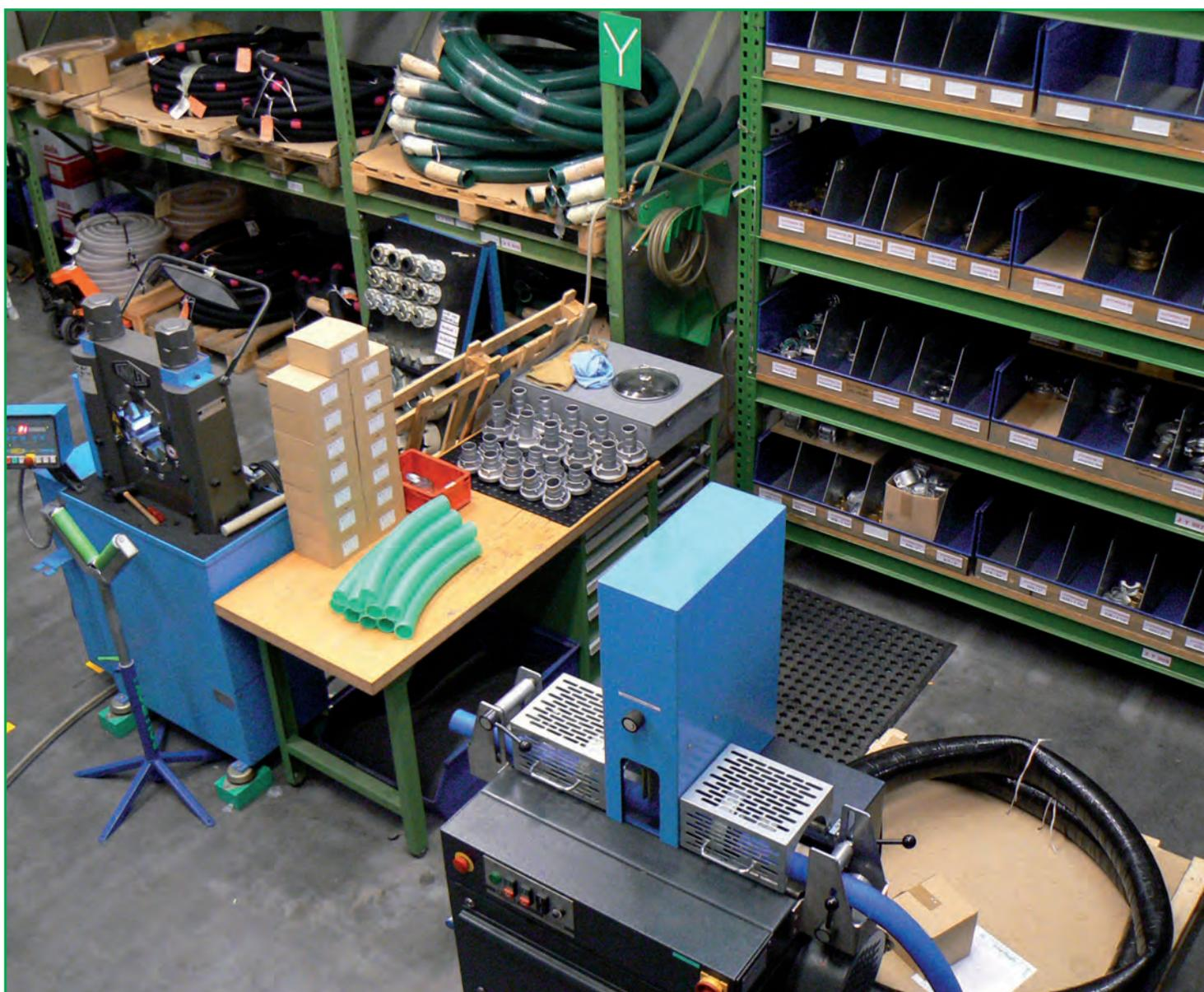
Teilansicht der LS-eigenen Schlauchkonfektion mit Armaturenlager für Industrie- und Spiralschlauchleitungen.
