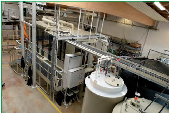
... für die Glasveredelung (Teilansicht) als Komplettlösung - angefertigt aus PP und PE HD mit Verrohrung
