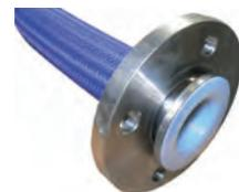
PTFE-Wellschlauch mit Spirale und Polypropylenumflectung sowie Losflansch aus Edelstahl mit gebördelter PTFE-Innenschicht
