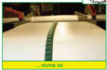
**Type LS 2155 2-lagiges PVC-Transportband weiß**, geeignet für Lebensmittel nach EG-Verordnung 1935/2004 und 10/2011 bzw. nach FDA 21 CFR 177.2600, 177.1680, mit Polyester einlagen, Tragseite 0,7 mm PVC, Laufseite 0,6 mm PVC, hauptsächlich zugelassen für rollende horizontale Abtragung, temperaturbeständig von -10 °C bis +100 °C
