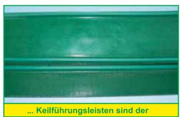
**Type LS 2068 2-lagiges PVC-Transportband grün**, mit Polyester einlagen, Tragseite mit Supergrip-Profil 3,2 mm stark, antistatisch, hauptsächlich für gleitende Steilförderung, temperaturbeständig von -15 °C bis +80 °C - nicht FDA konform
