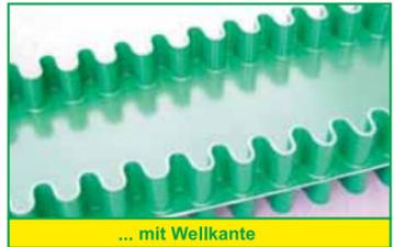
**Type LS 2135 2-lagiges PVC-Transportband grün**, mit Polyester einlagen, Tragseite 0,7 mm PVC, Laufseite jedoch friktioniert 0,9 mm PVC, hauptsächlich für rollende horizontale Abtragung, temperaturbeständig von -10 °C bis +80 °C - nicht FDA konform
